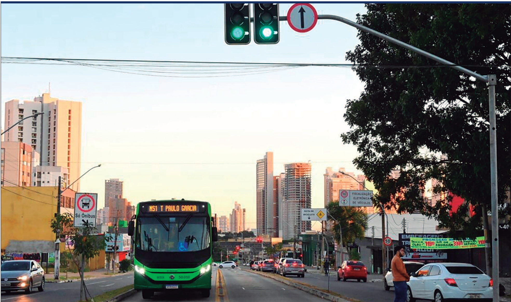
Sistema analisa o tráfego em tempo real e ajusta os sinais conforme a aproximação dos ônibus, o que cria ondas verdes dinâmicas
